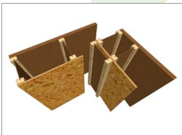
ROHOVÝ SPOJ - SKELETOVÁ KONSTRUKCE
