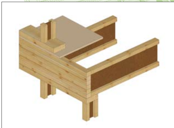
ZAKONČENÍ STROPU S BOČNÍM NOSÍKEM
